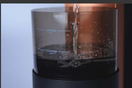
4. Premere il pulsante START per iniziare. Lasciar agire il detergente nel tubo per 5 minuti e pomparlo per completare la pulizia finché la piattaforma non si solleva.
