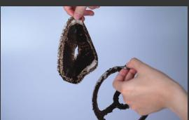
4. Lavare il modulo del filtro, il contenitore superiore inferiore e assicurarsi che non siano presenti residui nel filtro inferiore del contenitore superiore.
