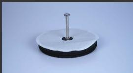
2. 紙フィルターの上に圧カリングを押し付けます。
