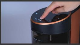
8. 根据配方设置开始冲泡。状态指示灯闪烁，显示冲泡正在进行。
