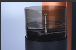
6. Pulire il contenitore inferiore dopo che la piattaforma si è sollevata. Pulire la parte inferiore della piattaforma con un panno morbido e umido.
